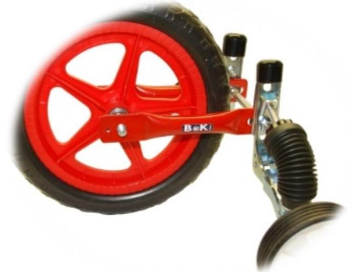
DOPO AVER MONTATO LA RUOTA ANTERIORE DELLA STWRRider INSERIRE LA RUOTA POSTERIORE CON LE STWheels NELLA FORCELLA, ATTENZIONE I DUE BRACCI VANNO ALL'INTERNO DELLA FORCELLA, ED AVVITARE LA VITE CON TESTA A CROCE.
